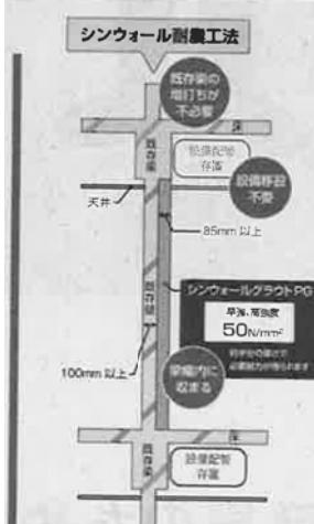
(50 N/mm<sup>2</sup>) を圧送充填し、従来よりも壁厚が薄い増打ち壁を構築する事で、工期短縮が図れ、また充填材の現場練り施工により、コンクリートポンプ車等の大型車両の設置が困難な建物の補強工事への対応が可能となる。
